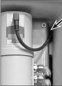
Fig. 10-1: fente supérieure d'env. 10 mm pour passer les câbles de commande et de sonde d'impulsions
