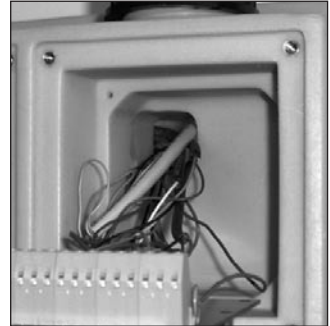
Fig. 10-1: fente supérieure d'env. 10 mm pour passer les câbles de commande et de sonde d'impulsions
